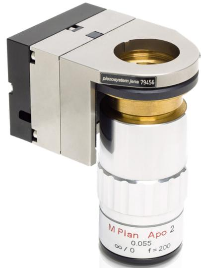
Der nanoMIPOS 400 bietet einen **Positionier- und Scanbereich bis zu 400µm im ungerelgten und 320µm im geregelten Betrieb**. Das System kann mit Objektiven von bis zu **39mm Durchmesser und 1kg Gewicht** eingesetzt werden. Das System zeigt eine **geringe Verkippung von <5 µrad**.
